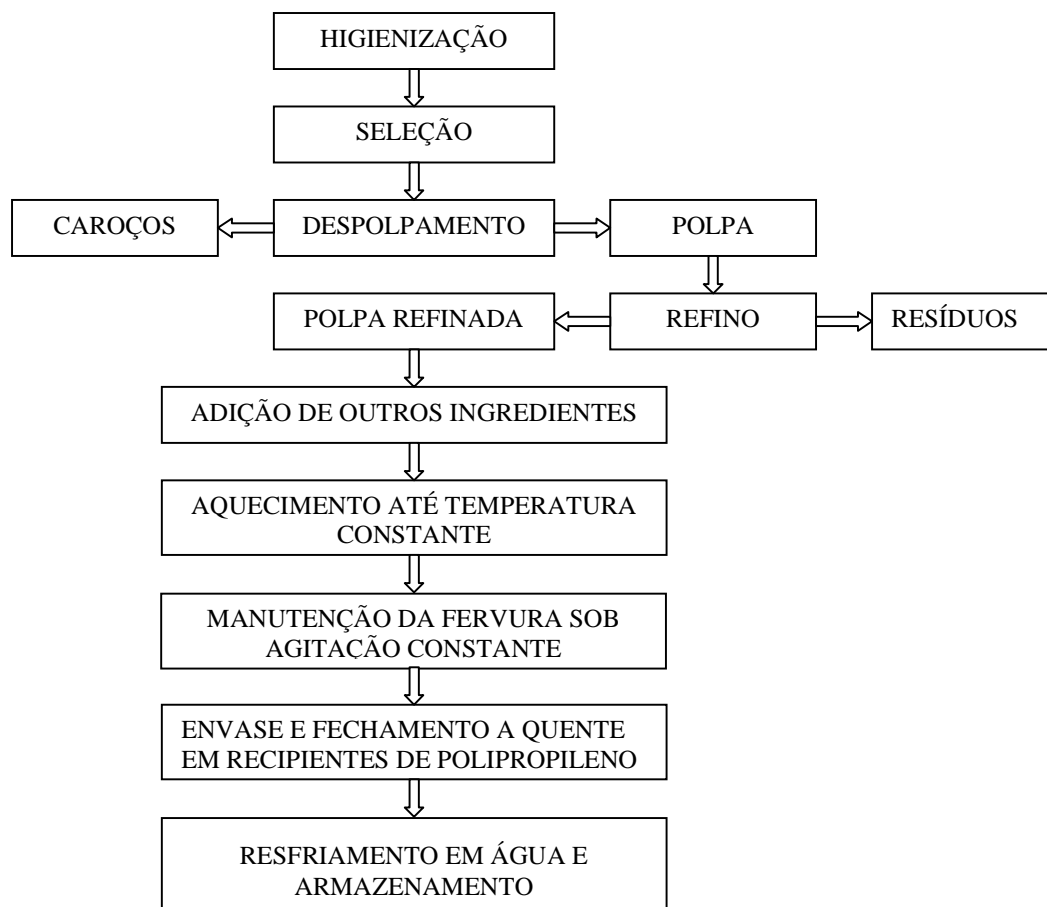
FIGURA 1 – Diagrama de blocos do processamento dos doces de cajá
